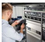
Gedraaide schuifladen maken een ergonomische bediening vanaf de buitenkant van het voertuig mogelijk
